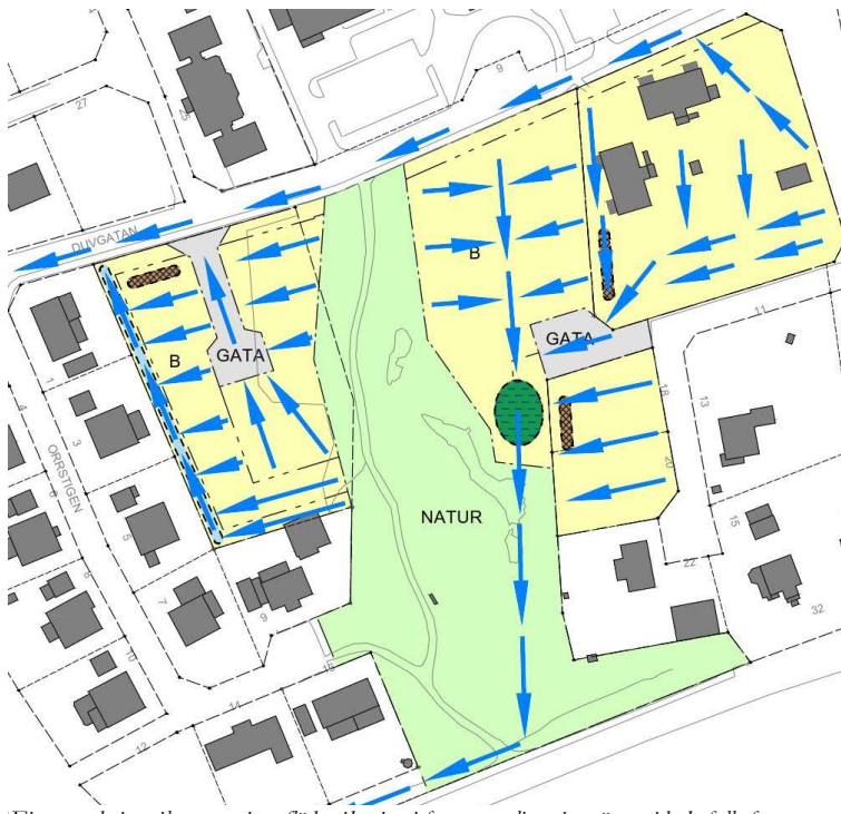
Figur med rinnpilar som visar flödesriktning i form av ytliga rinnvägar vid skyfall efter exploatering av planområdet.
