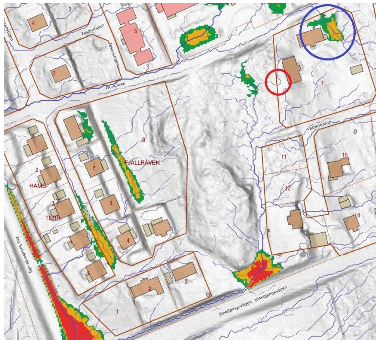
Karta över områden som visar vattensamlingar samt rinnvägar vid ett regndjup av 50 millimeter. Grön färg visar vattendjup upp till 10 centimeter, gul färg visar 10-30 centimeter och röd färg visar djup över 30 centimeter
